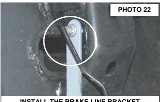
**INSTALL THE BRAKE LINE BRACKET**
