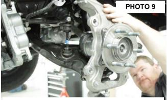
LOOSEN LOWER BALL JOINT
