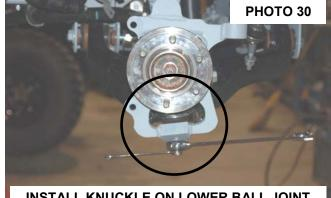
**INSTALL KNUCKLE ON LOWER BALL JOINT**
